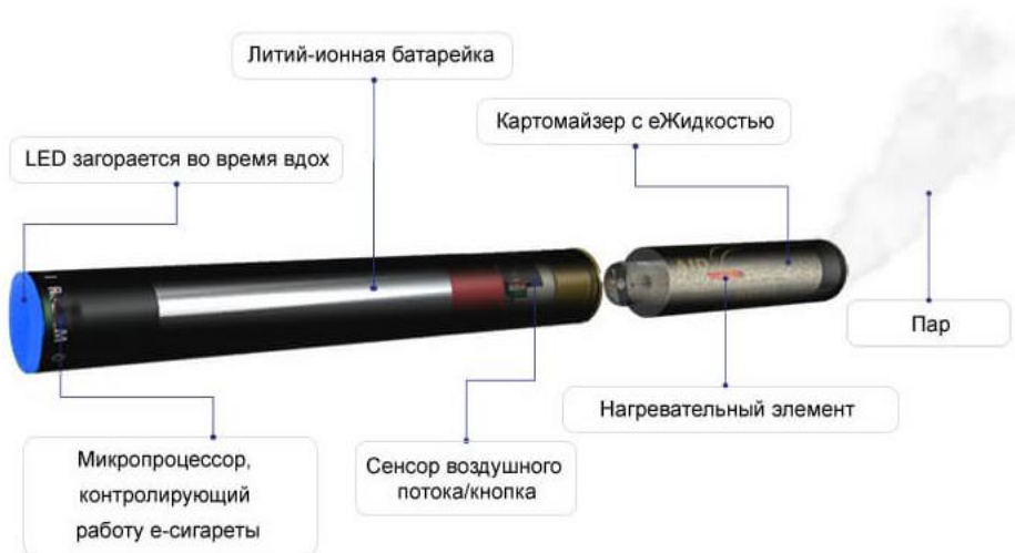
Рис. 1 – Устройство электронной сигареты
